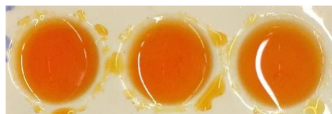
Figura 15. Resultados de la prueba con el método propuesto, añadiendo 4 gotas de \text{Cu}(\text{NO}_3)_2 y 8 gotas de neocuproína. Se puede observar un color naranja más intenso en los tres pozos.
