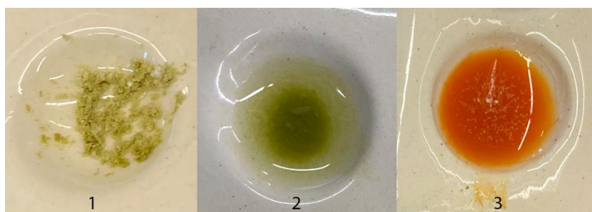
Figura 18. Prueba de reactividad del compuesto sintetizado. De izquierda a derecha, Mezcla compuesto en sólido, este no reacciona al solo agregarle la muestra de acetaminofén (1), control negativo ( [Cu(neo)_2]^{2+} en agua destilada) (2), control positivo [Cu(neo)_2]^{2+} con 0.002g de acetaminofén y agua (3).
