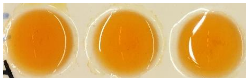
Figura 14. Resultados de la prueba con el método propuesto, añadiendo 8 gotas tanto de \text{Cu}(\text{NO}_3)_2 como de neocuproína. Se puede observar una coloración naranja en los tres pozos.
