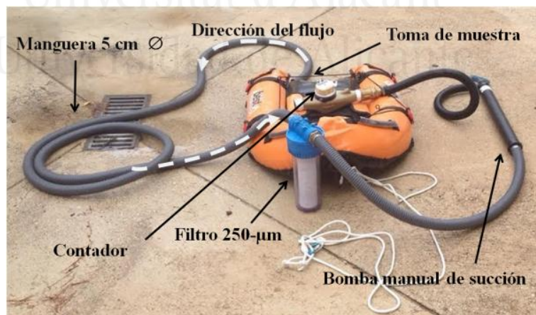
Figura 9.2. Bomba manual de succión con luz de malla de 250- \mu m. La muestra se queda retenida en la parte exterior del filtro cilíndrico.
