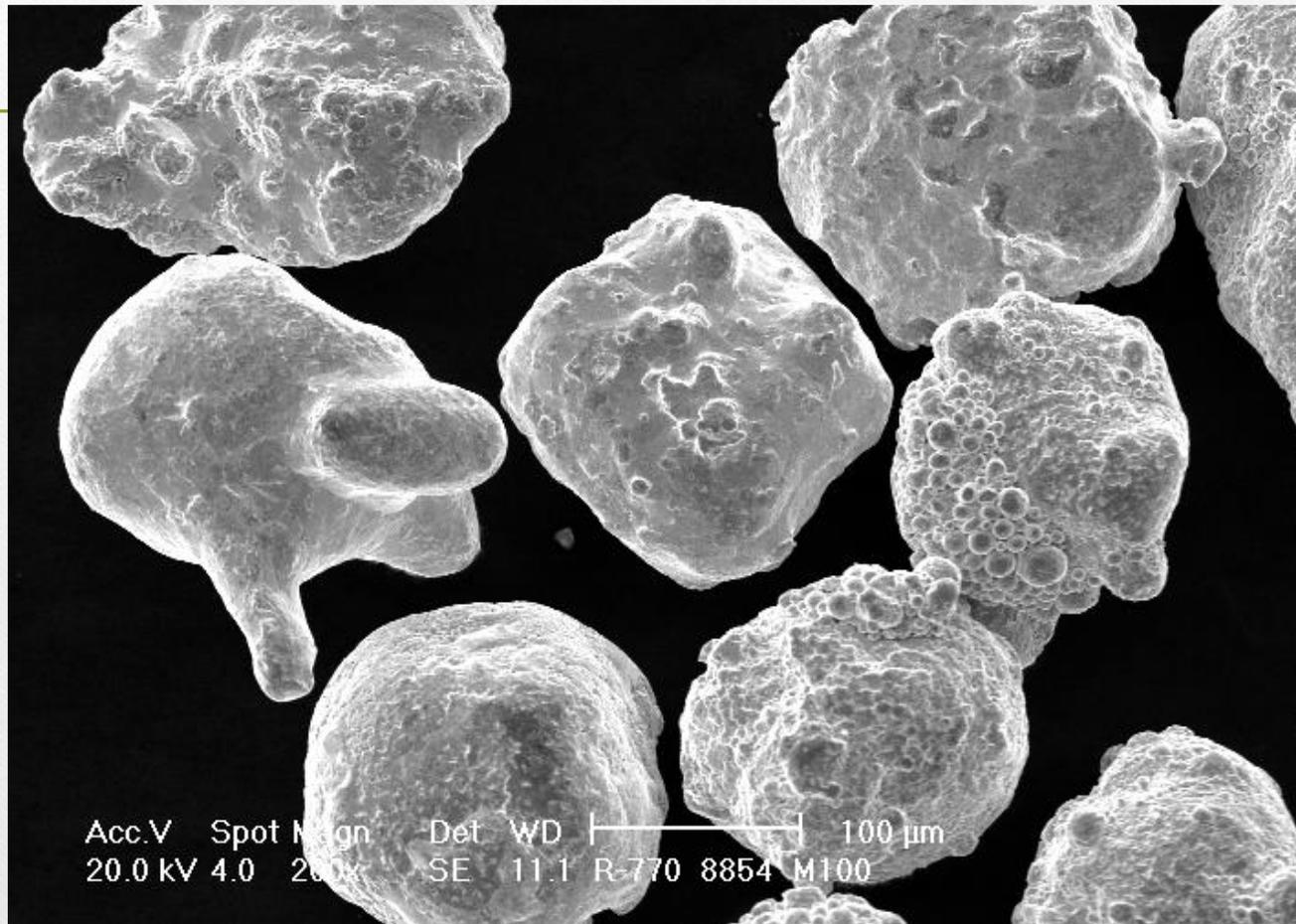
**FIG. 4.11** Dada la baja solubilidad en estado sólido el cobre y el plomo se separan durante la solidificación dando como resultado una matriz de cobre (tonalidad más oscura) sobre la cual se deposita el plomo [Udiatem FI UNAM].
