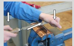
Vorhub mit Druck Rückhub ohne Druck (Feilenlänge nutzen)
