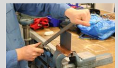
Entgraten in Längsrichtung der gefeilten Kante
