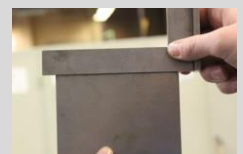
Ebenheit mit Augenmaß und Anschlagwinkel prüfen
