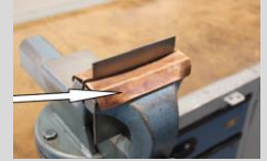
Werkstück mittig fest einspannen, Kupferschutzbacken verwenden!
