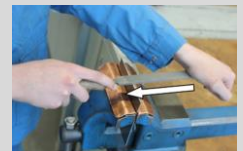
Gleichmäßige Vorschubbewegung nach beiden Seiten bewirkt gleichmäßige Spanabnahme
