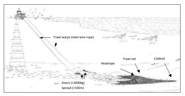
FIGURE 4-10: TYPICAL GEAR CONFIGURATION USED BY DEMERSAL TRAWLERS (OFFSHORE) TARGETING HAKE.
