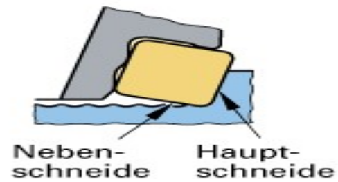
Planfräser mit Wendeschneidplatte
