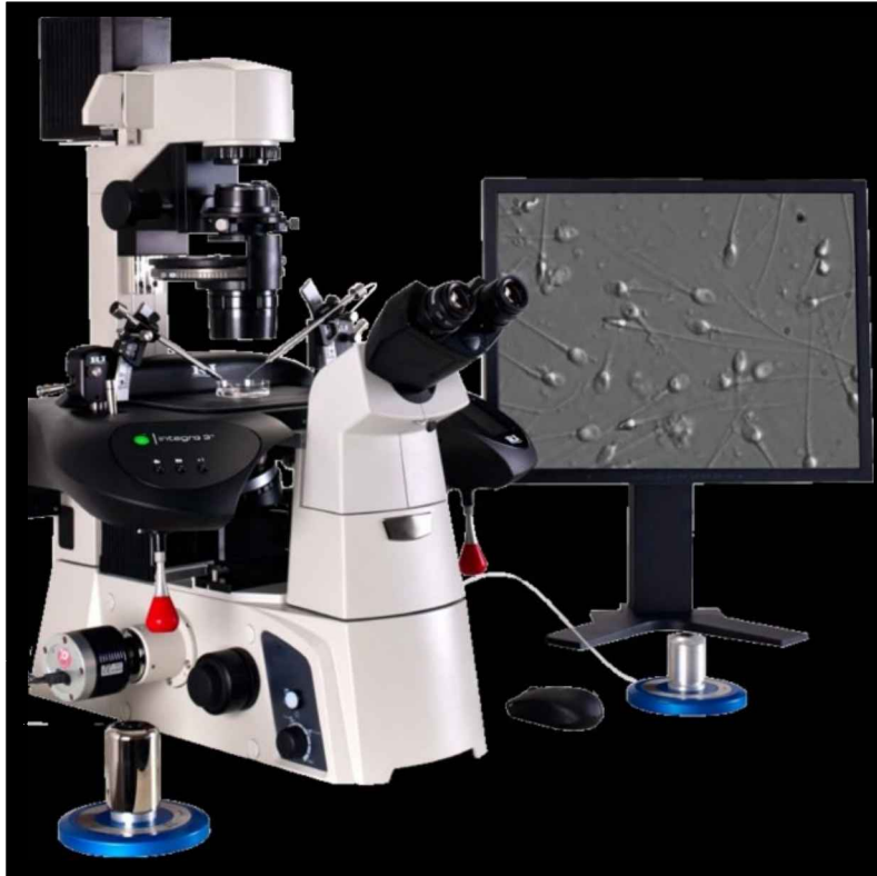
Figura 4. Estación de trabajo de IMSI.
