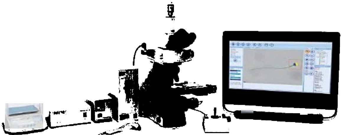
Figura 6: Configuración del sistema CASA similar a la Fig. 5, pero con etapa motorizada completamente automatizada y epifluorescencia para el seguimiento de espermatozoides de muestras sucias, reacción del acrosoma y detección de fragmentación de fluorescencia. También se muestra una balanza (extremo izquierdo) para determinar el peso del volumen de semen (ilustración con permiso de Microptic SL, Barcelona, España).
