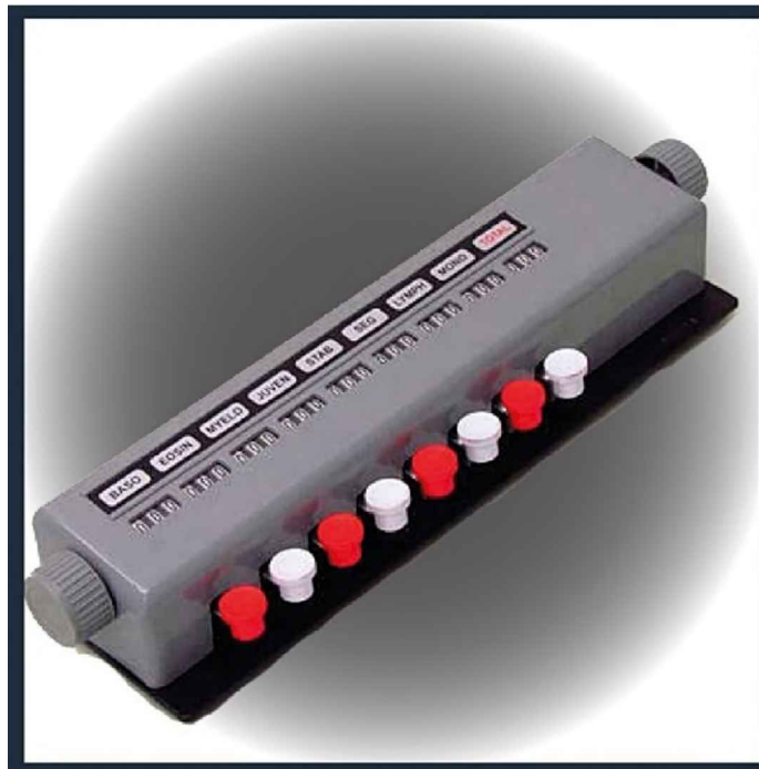
Figura 20. Contador de células mecánico; permite el conteo de espermatozoides individuales con sus diferentes anomalías.
