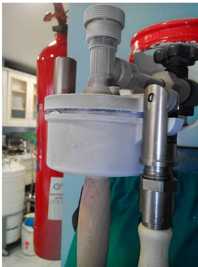
Figura 1. Bombona de CO 2 con sonda y adaptador para preparar el hielo seco.
