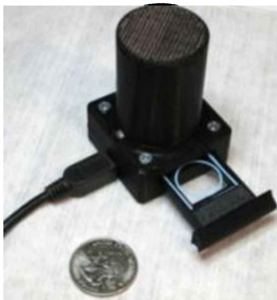
Figura 14: Un microscopio holográfico en chip rentable compuesto por un sensor de imagen CMOS y un LED filtrado por un agujero de alfiler.
