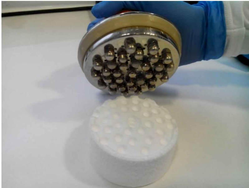
Figura 4. Orificios en el hielo seco.
