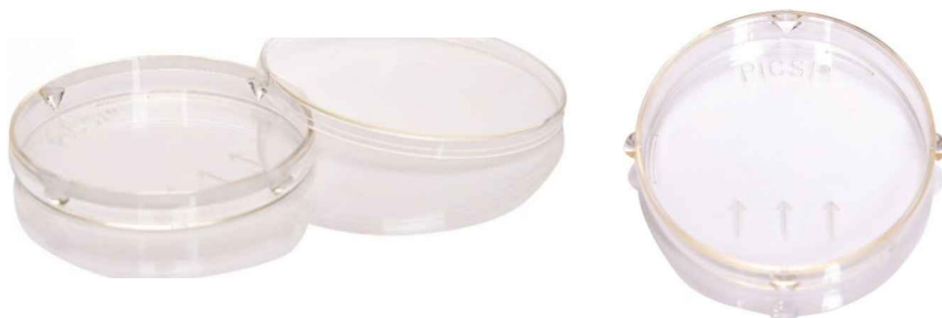
Figura 5. La placa PICSI muestra las puntas de flecha que indican la ubicación de los puntos de hialuronato.
