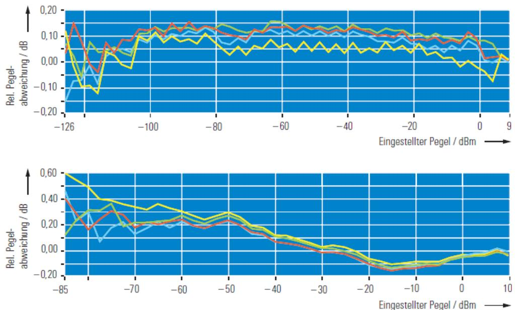
Bild 1-16: Die gemessene relative Pegelabweichung vom eingestellten Pegel bei einer mechanisch Eichleitung (oben) und bei der elektronischen Eichleitung (unten). Blau: 89 MHz, rot: 900 MHz, grün: 1,9 GHz, gelb: 3,3 GHz.
