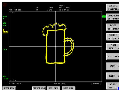
Bild 1-17: Darstellung eines von einem Vektor-Signalgenerator erzeugten Signals im IQ-Diagramm
