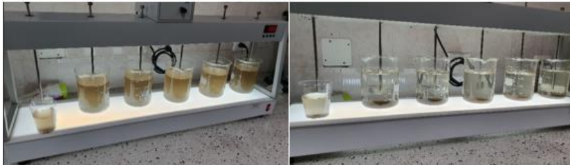
Figura 29. Ensayo de jarras para determinación de dosis óptima, turbiedad baja (antes y después)
