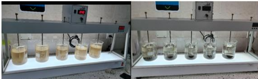
Figura 30. Ensayo de jarras para determinación de dosis óptima, turbiedad media (antes y después)
