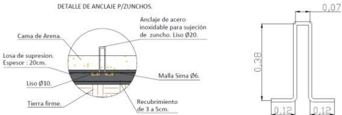
Figura 5 Detalle de anclaje para zunchos
