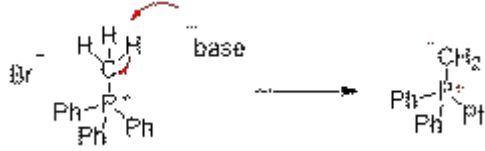
Figura 4.21. Formación del iluro de fósforo.
