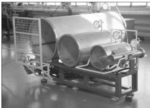
Ryc. 8. Stanowisko do badania narzędzi pneumatycznych (widok od strony operatora)
