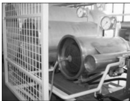
Ryc. 11. Próby eksploatacyjne na stanowisku do badania pneumatycznych poduszek uszczelniających
