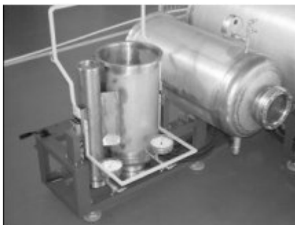
Ryc. 10. Stanowisko do badania narzędzi pneumatycznych: a) system zasilania wodą, b) rury testowe wychylne
