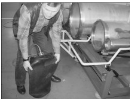
Ryc. 11. Próby eksploatacyjne na stanowisku do badania pneumatycznych poduszek uszczelniających
