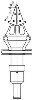
Ryc. 14. Przykładowa charakterystyka rozpieracza szczękowego: a) – przebieg siły w funkcji przemieszczenia końcówek roboczych, b) – punkty mocowania narzędzia
