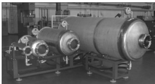
Ryc. 9. Stanowisko do badania narzędzi pneumatycznych (widok od strony okien inspekcyjnych)
