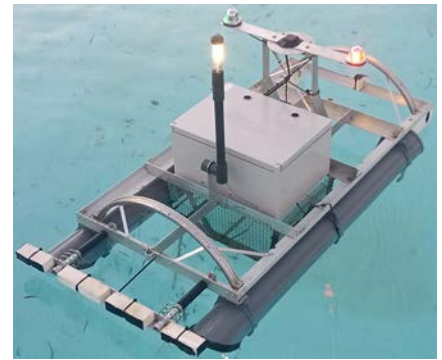
Fig. 2.- Fotografía del USV. Se aprecian las luces de todo horizonte, babor (encendida), estribor y la antena negra del GPS.
