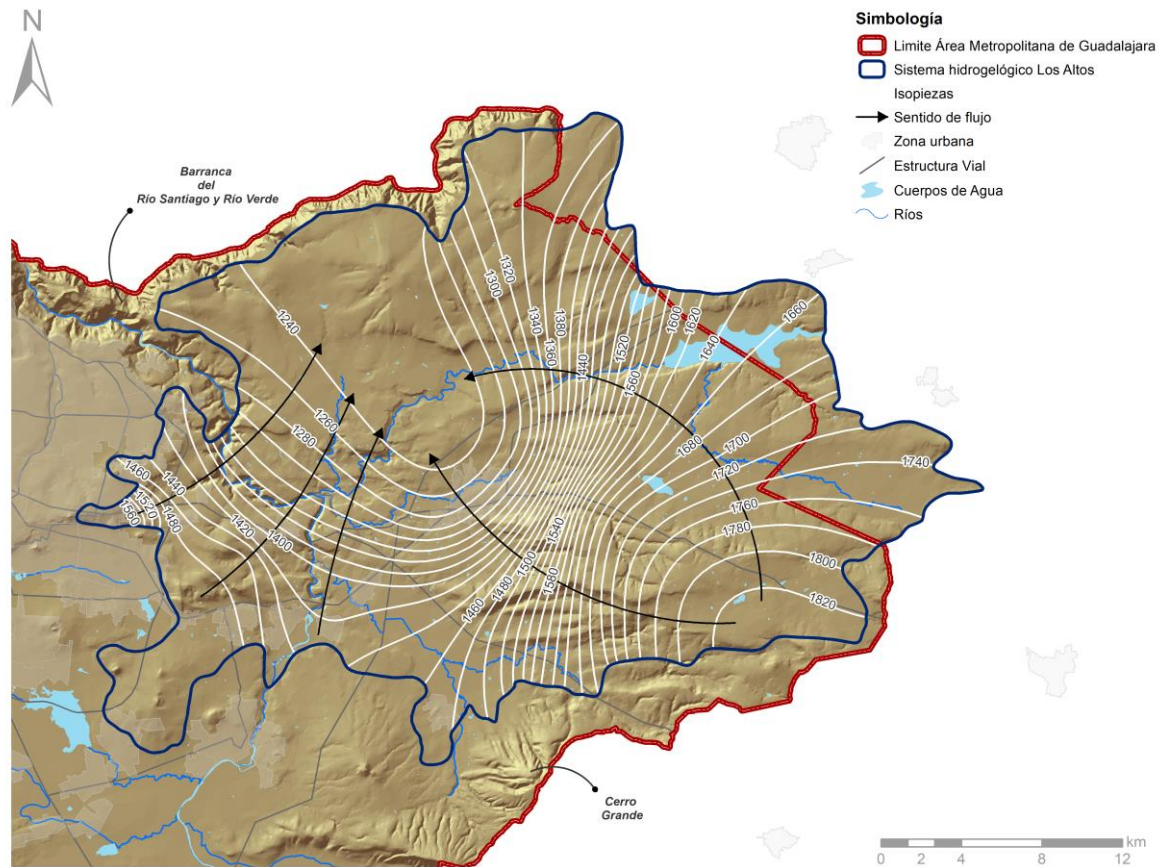
Figura 120. Isopiezas y sentido del flujo modelados para el sistema Los Altos.
