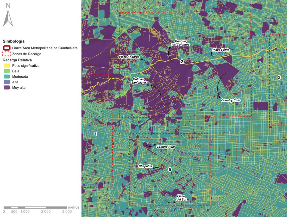
Figura 65. Mapa de la recarga relativa de agua subterránea en las Zonas “Parque Colomos” y “El área de la Cuenca del Chicalote”. Elaboración propia mediante la metodología propuesta por Piscopo (2001).
