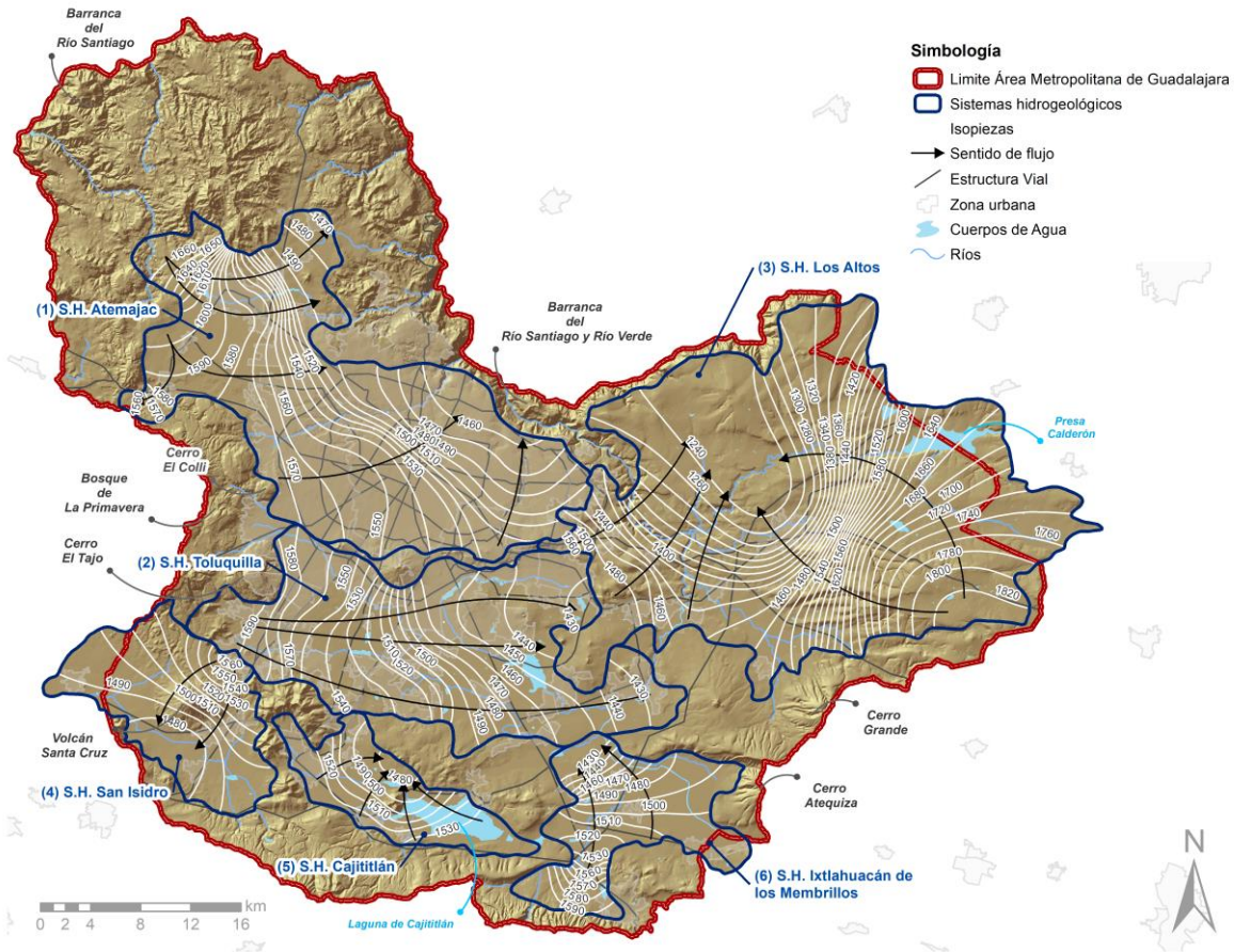
Figura 17. Isopiezas con flechas ortogonales que indican el sentido del flujo para los seis sistemas hidrogeológicos del AMG. Fuente: elaborado por Enlace Ambiental y Proyectos.
