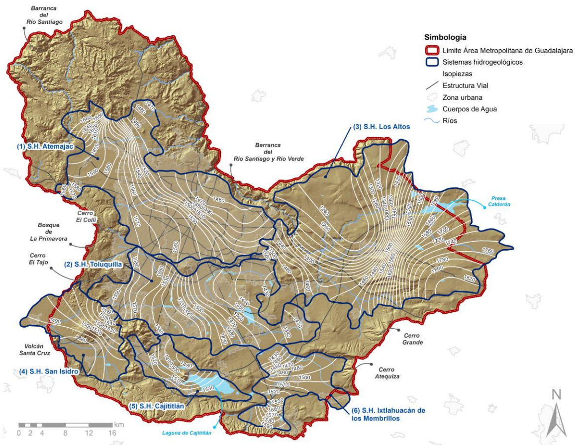
Figura 16. Isopiezas suavizadas para los seis sistemas hidrogeológicos del AMG.
