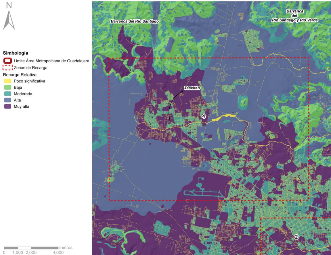
Figura 67. Mapa de la recarga relativa de agua subterránea en las Zonas "Zona Tesistán". Elaboración propia mediante la metodología propuesta por Piscopo (2001).
