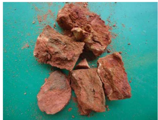
Figura 62: SP-02 Amostra 04/06 – Profundidade: 1,00 a 1,45m Classificação do Material: Silte arenoso, pouco a medianamente argiloso, medianamente a compacto, de cor variegado com predominância avermelhado. (Fonte: PCA Engenharia, 2018).
