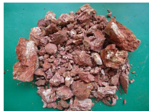
Figura 57. SP-01 Amostra 04/05 – Profundidade: 1,00 a 1,45m Classificação do Material: Silte argiloso, pouco arenoso, duro, com intercalação de lateritas friáveis, de cor variegada com predominância vermelho. (Fonte: PCA Engenharia, 2018).
