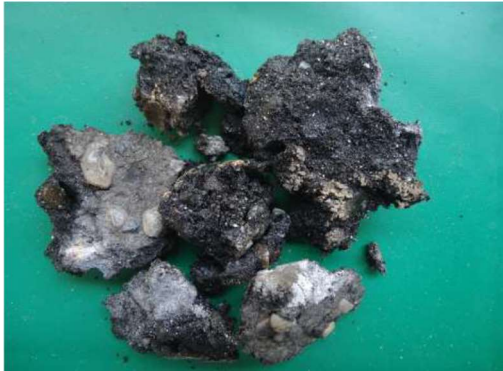
Figura 54. SP-01 Amostra 01/05 – Profundidade: 0,00 a 0,04m Classificação do Material: Asfalto. (Fonte: PCA Engenharia, 2018).
