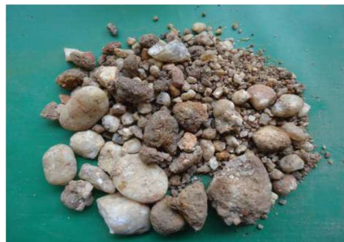
Figura 75. SP-04 Amostra 04/09 – Profundidade: 1,00 a 1,45m Classificação do Material: Silte arenoso, pouco a medianamente argiloso, pouco compacto, a fofo, com pedregulho de seixo de cor marrom pouco escuro. (Fonte: PCA Engenharia, 2018).
