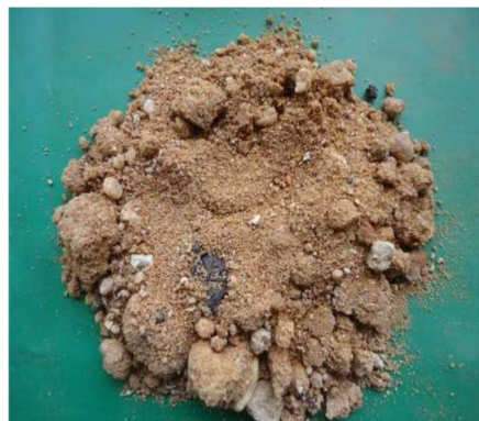
Figura 74: SP-04 Amostra 03/09 – Profundidade: 0,09 a 0,77m Classificação do Material: Silte arenoso, com pedriscos e pedras de seixo de cor marrom. (Fonte: PCA Engenharia, 2018).
