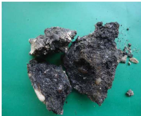
Figura 72. SP-04 Amostra 01/09 – Profundidade: 0,00 a 0,02m Classificação do Material: Asfalto. (Fonte: PCA Engenharia, 2018).
