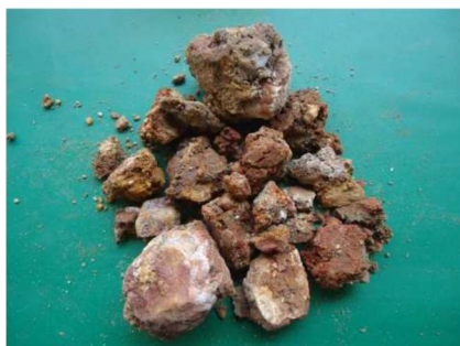
Figura 77. SP-04 Amostra 07/09 – Profundidade: 4,00 a 4,45m Classificação do Material: Silte, pouco argiloso, compacto, de cor roxa, com veios brancos. (Fonte: PCA Engenharia, 2018).
