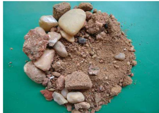
Figura 56. SP-01 Amostra 03/05 – Profundidade: 0,11 a 0,40m Classificação do Material: Silte arenoso, com pedras de seixo, e resto de material de demolição, de cor marrom. (Fonte: PCA Engenharia, 2018).
