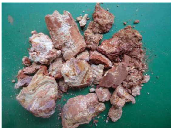
Figura 64: SP-02 Amostra 06/06 – Profundidade: 3,00 a 3,12m Classificação do Material: Silte argiloso, duro, com intercalação de areia, e laterítas friáveis, de cor variegado. (Fonte: PCA Engenharia, 2018).
