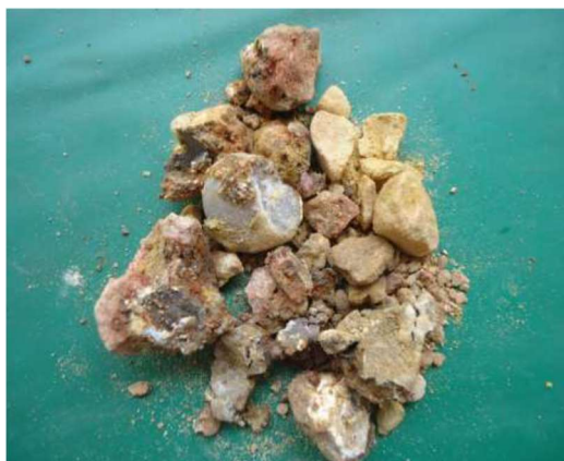
Figura 79. SP-04 Amostra 09/09 – Profundidade: 6,00 a 6,45m Classificação do Material: Silte, pouco argiloso, compacto, de cor roxa, com veios brancos. (Fonte: PCA Engenharia, 2018).
