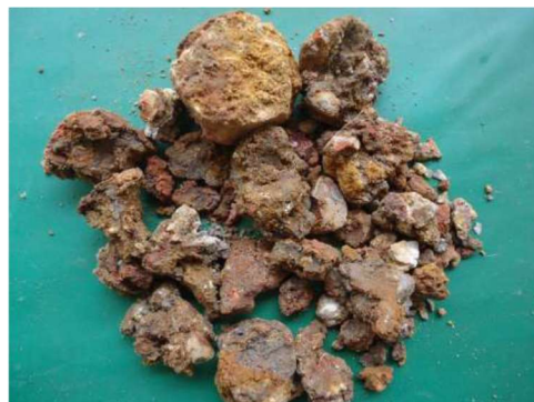
Figura 78. SP-04 Amostra 08/09 – Profundidade: 5,00 a 5,45m Classificação do Material: Silte, pouco argiloso, compacto, de cor roxa, com veios brancos. (Fonte: PCA Engenharia, 2018).
