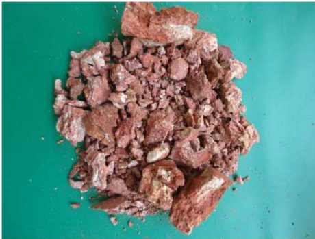
Figura 58: SP-01 Amostra 05/05 – Profundidade: 2,00 a 2,45m Classificação do Material: Silte argiloso, pouco arenoso, duro, com intercalação de lateritas friáveis, de cor variegada com predominância vermelho. (Fonte: PCA Engenharia, 2018).
