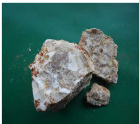
Figura 73. SP-04 Amostra 02/09 – Profundidade: 0,02 a 0,09m Classificação do Material: Pedra de Calçamento. (Fonte: PCA Engenharia, 2018).
