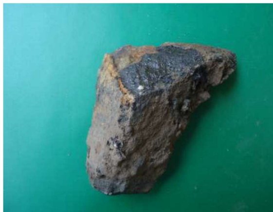
Figura 65: SP-03 Amostra 01/07 – Profundidade: 0,00 a 0,06m Classificação do Material: Pedra de Calçamento. (Fonte: PCA Engenharia, 2018).
