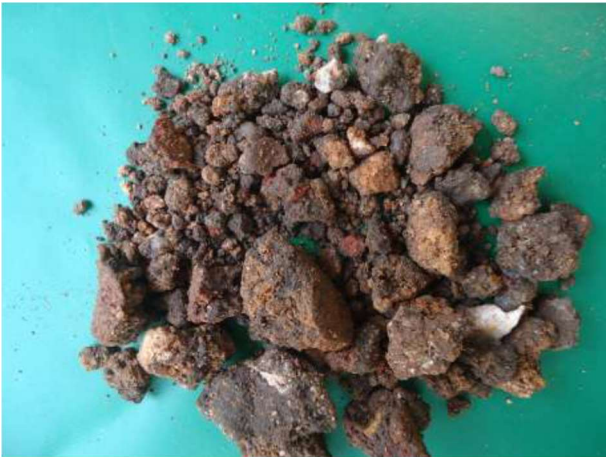
Figura 67: SP-03 Amostra 03/07 – Profundidade: 1,00 a 1,45m Classificação do Material: Silte arenoso, pouco a medianamente argiloso, medianamente compacto, com pedaços de pedras, de cor pouco escuro. (Fonte: PCA Engenharia, 2018).
