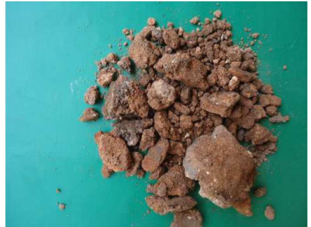
Figura 69: SP-03 Amostra 05/07 – Profundidade: 3,00 a 3,45m Classificação do Material: Silte arenoso, pouco argiloso, medianamente com pacto, com pedriscos de seixo, de cor marrom. (Fonte: PCA Engenharia, 2018).
