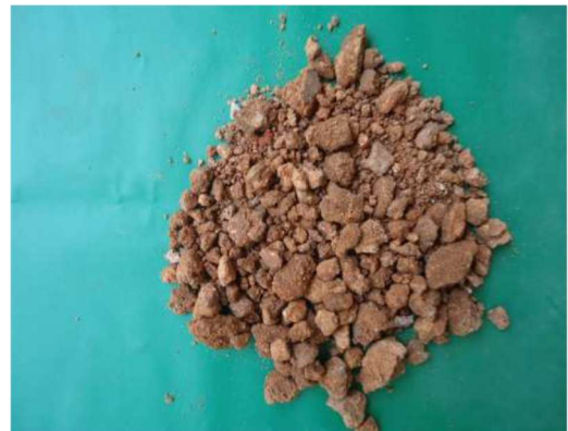
Figura 70. SP-03 Amostra 06/07 – Profundidade: 4,00 a 4,45m Classificação do Material: Silte arenoso, pouco argiloso, medianamente com pacto, com pedriscos de seixo, de cor marrom. (Fonte: PCA Engenharia, 2018).
