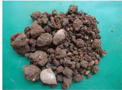
Figura 61: SP-02 Amostra 03/06 – Profundidade: 0,10 a 0,52m Classificação do Material: Silte arenoso, com pedras de seixo, e resto de material de demolição, de cor marrom. (Fonte: PCA Engenharia, 2018).
