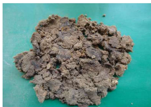
Figura 76. SP-04 Amostra 05/09 – Profundidade: 2,00 a 2,45m Classificação do Material: Areia fina, pouco argilosa, fofo, de cor cinza e marrom. (Fonte: PCA Engenharia, 2018).
