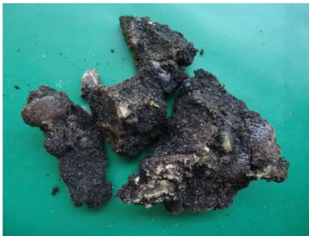
Figura 59: SP-02 Amostra 01/06 – Profundidade: 0,00 a 0,03m Classificação do Material: Asfalto. (Fonte: PCA Engenharia, 2018).
