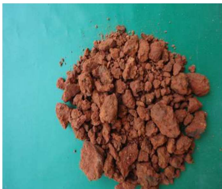
Figura 71. SP-03 Amostra 07/07 – Profundidade: 5,00 a 5,45m Classificação do Material: Silte areno-argiloso, compacto, com pedregulho de laterita miúda, de cor vermelho. (Fonte: PCA Engenharia, 2018).
