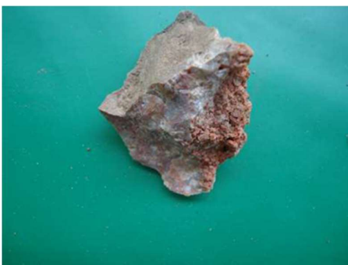
Figura 55. SP-01 Amostra 02/05 – Profundidade: 0,04 a 0,11m Classificação do Material: Pedra de Calçamento. (Fonte: PCA Engenharia, 2018).
