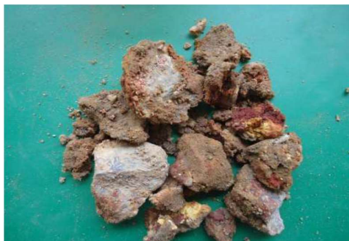
Figura 76. SP-04 Amostra 06/09 – Profundidade: 3,00 a 3,45m Classificação do Material: Silte areno-argiloso, fofo a compacto, com fragmentos de pedras de mão, de quartzo, (Fonte: PCA Engenharia, 2018).
