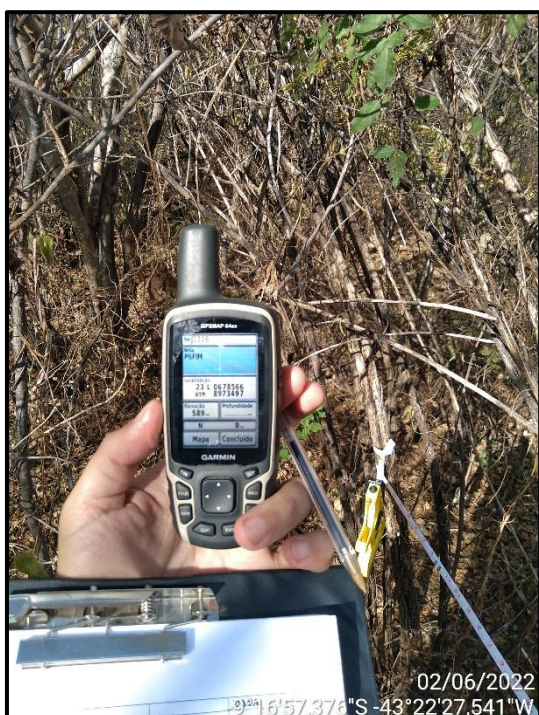
FOTO 6.2.4.5 – Obtenção dos pontos de coordenadas UTM da unidade amostral, por meio de aparelho GPS.
