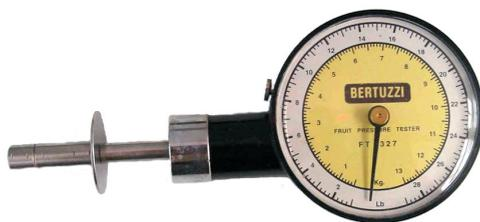
Figura 13 Penetrómetro para medir firmeza de frutas
