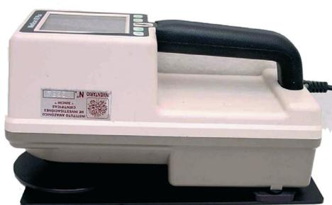
Figura 14. Colorímetro espectrofotómetro MiniScan XE Plus
