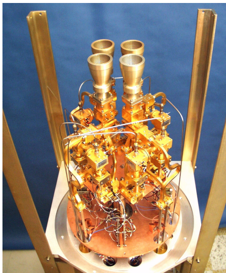
Obrázek 7.6: Přijímač dalekohledu GBT pro pásmo Q ( f = 40 až 52 GHz, tj. \lambda = 7,5 až 5,77 mm). Nahoře jsou patrné čtyři napájecí trychtýře (vlnovody), pod nimi zdroje pro kalibraci, předzesilovače, lokální oscilátor, směšovač (mixer), kabely k mezifrekvenčním zesilovačům (IF). Tento stupeň je chlazen teplotu 20 K. Převzato z http://www.cv.nrao.edu/course/astr534/Radiometers.html .
