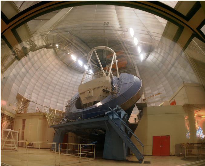
Obrázek D.3: Dalekohled Mayall na observatoři Kitt Peak. Průměr primárního zrcadla činí 4 m, použita byla varianta rovníkové vidlicové montáže.
