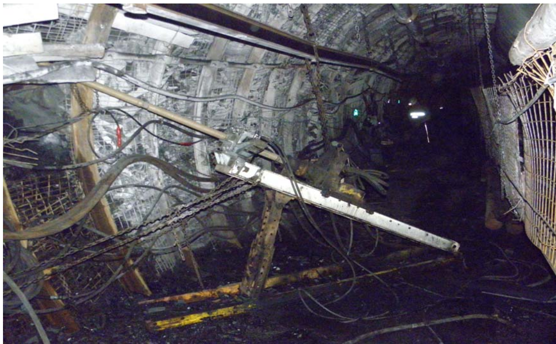
Obr.č.6-vrtání degazačních vrtů na důlní třídě sloje č.084.
