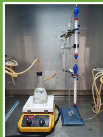
Sistema experimental para la carbonación de pellets del material reactivo
