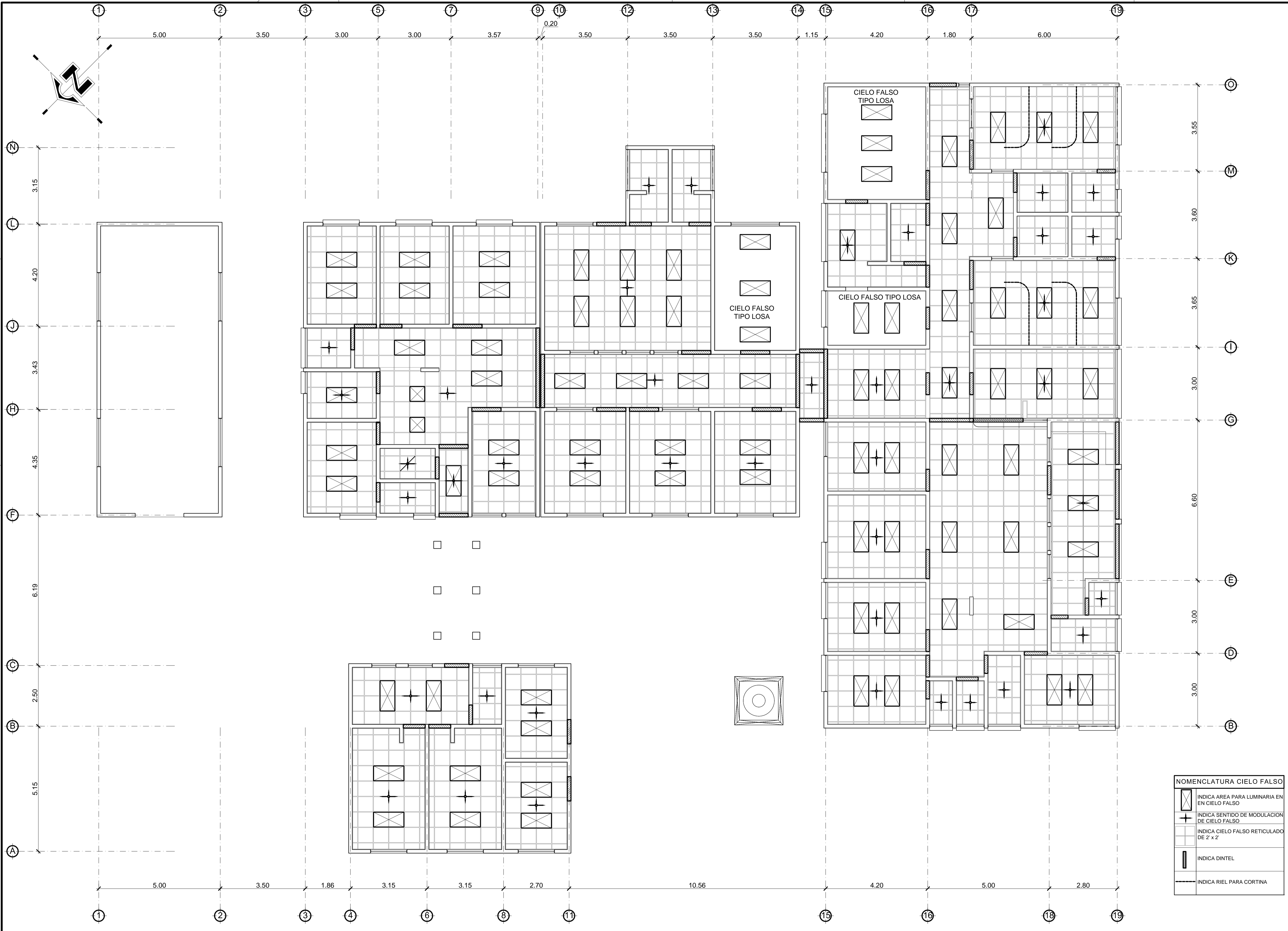
PLANTA MODULACION DE CIELO FALSO CENTRO DE SALUD -TZETUN IXCAN.
