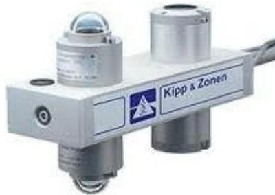
Radiometro netto a quattro componenti: composto da due piranometri, per le misure di onde corte (radiazione solare), e due pirgeometri, per le misure di onde lunghe (radiazione atmosferica e terrestre).
