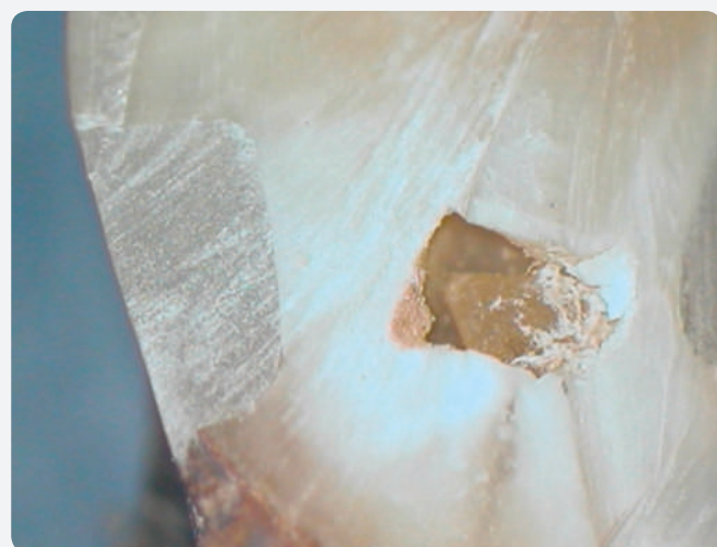
Figura 1. Ausencia de filtración del XPS.
