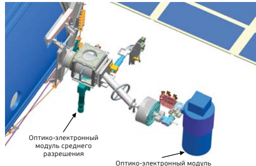
Рис. 1. Схема размещения оптоэлектронных модулей на российском сегменте МКС
