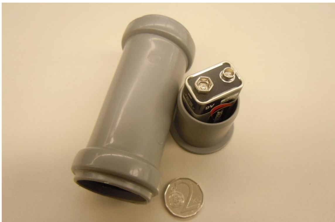
Obrázek 11. Vodotěsné pouzdro plašiče s napájecí 9V baterií.
