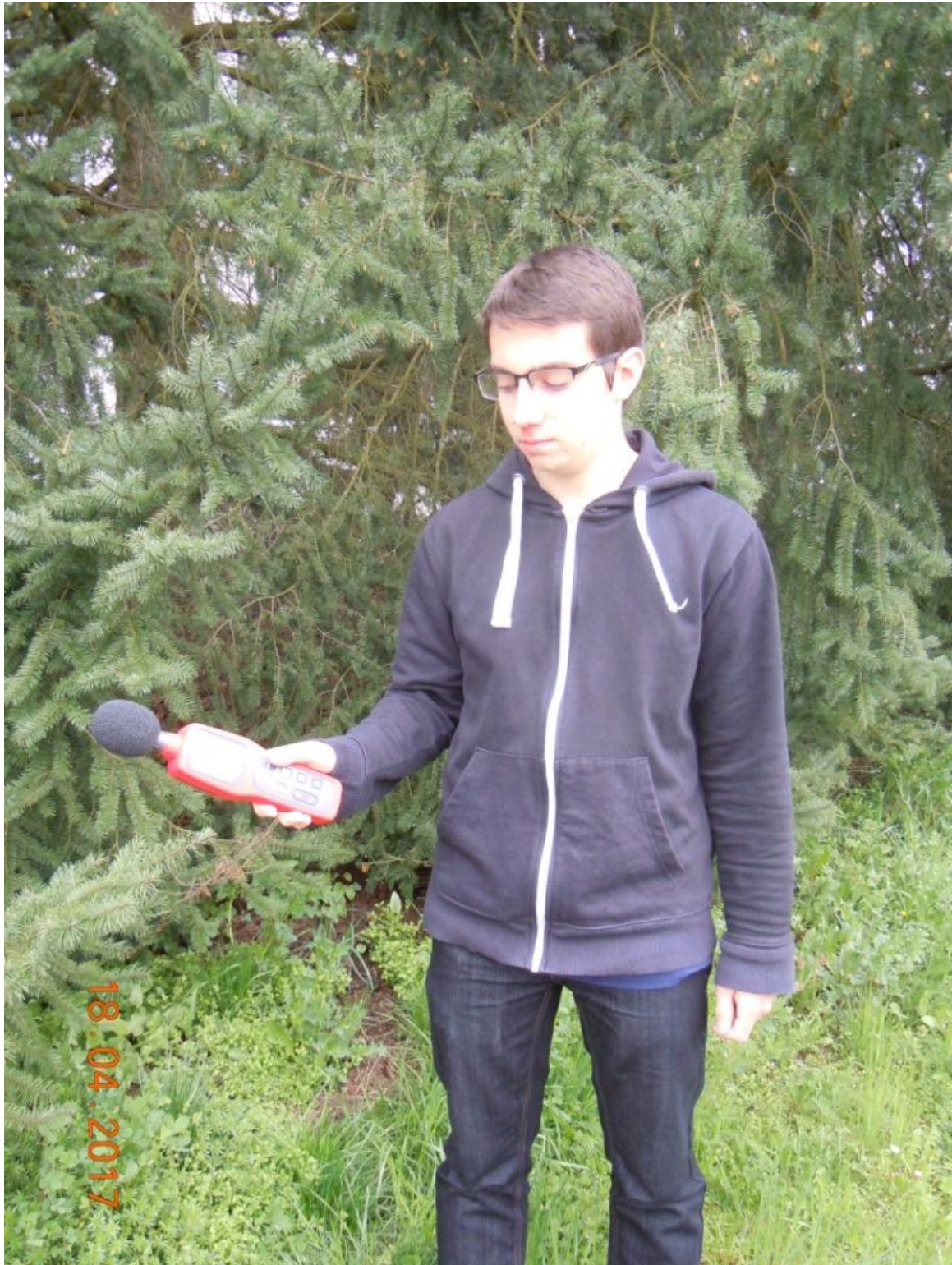
Obrázek 4. Měření hlasitosti plašiče přenosným hlukoměrem v terénu.
