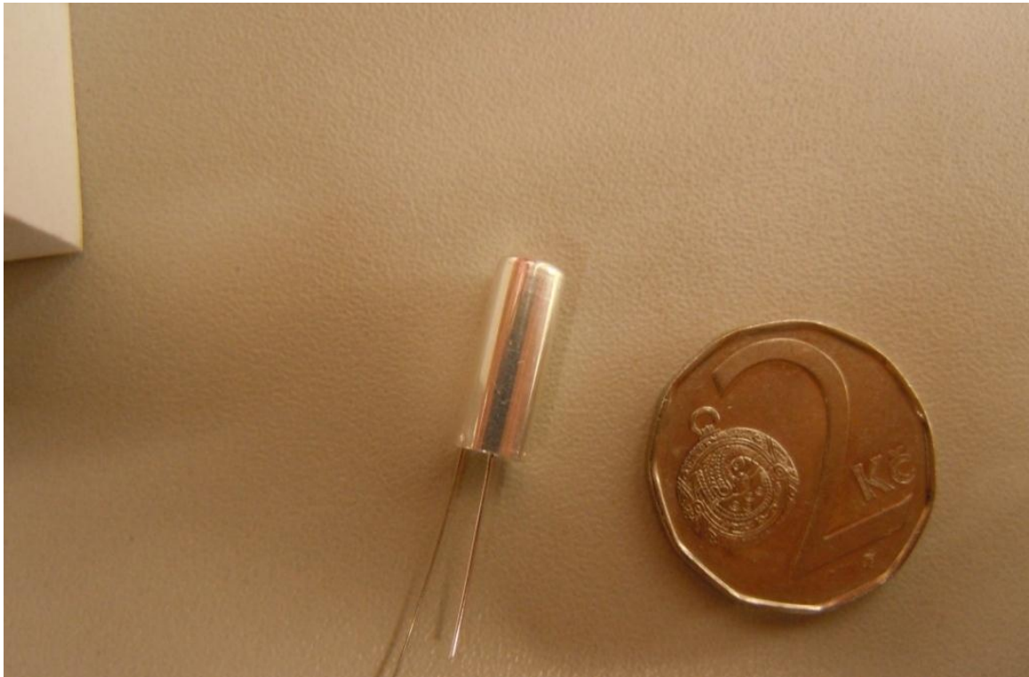
Obrázek 7. Provedení kuličkového polohového spínače napájení plašiče.
