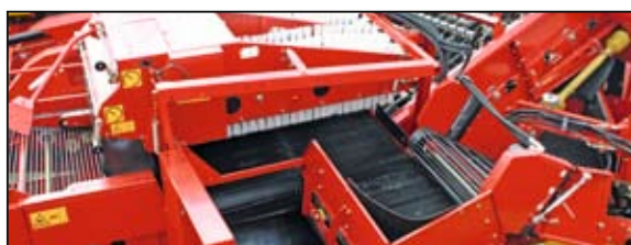
Modelo SB: graças ao separador de pedras, absolutamente inovador e funcionando através de tecnologias cinéticas, a máquina consegue resultados de separação aperfeiçoados em terreno pedregoso
