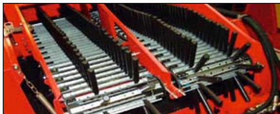
Modelo UB: os melhores resultados de separação para terrenos cheios de torrões e com poucas pedras
