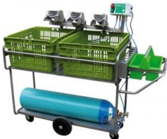
Figur 5. Pigsleeper, utrustningen som går att köpa i Nederländerna för koldioxidbedövning.
