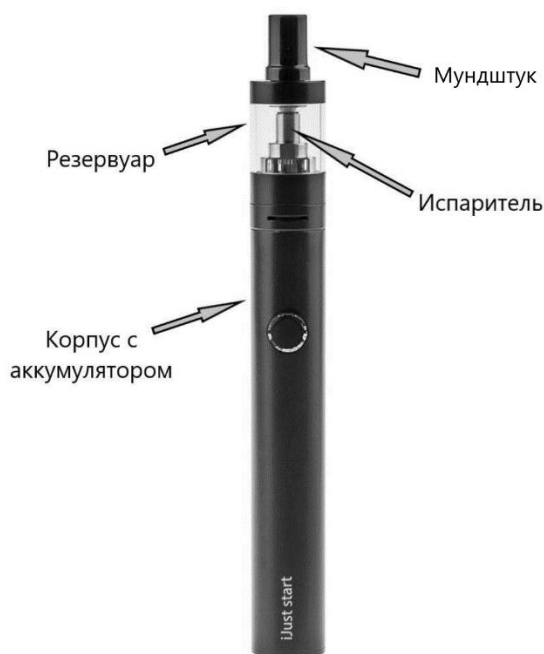
Рисунок 2- Устройство электронной сигареты
