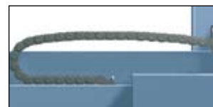
■ Kabelsläpkedja utan extra belastning (kablar och slangar)
