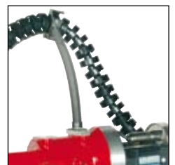
Hållare monterad på spiralfjäder.
