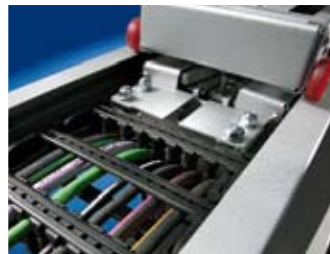
Automatiskt nödstopp med urkoppling av kabelsläpkedjan.
