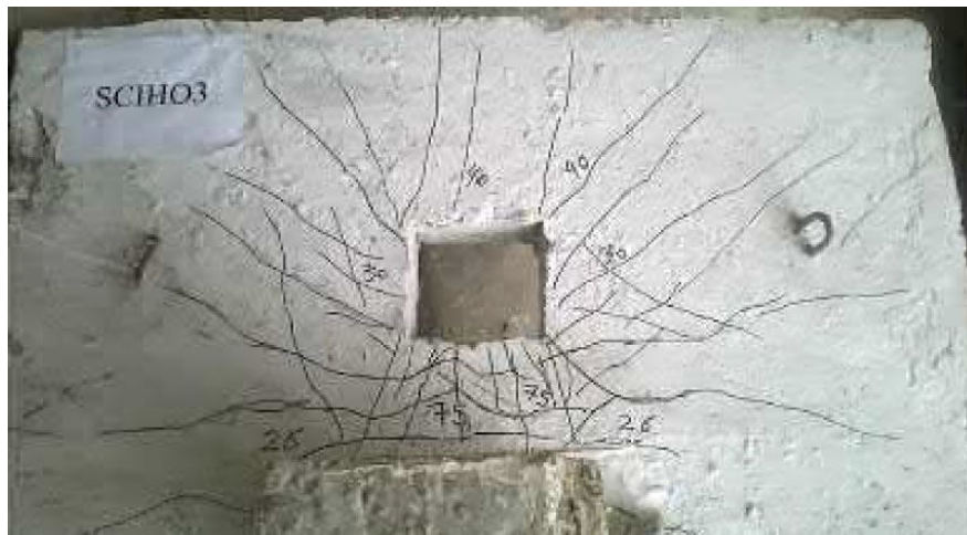
Figura 44: Quadro fessurativo post rottura per taglio/punzonamento nel caso di apertura in prossimità del pilastro; vista piastra dal basso.
