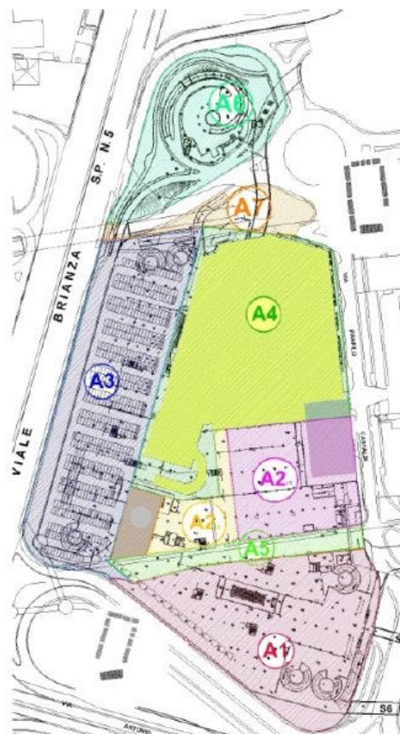
Figura 57: Centro commerciale Auchan a Cinisello Balsamo; suddivisione del fabbricato in corpi.
