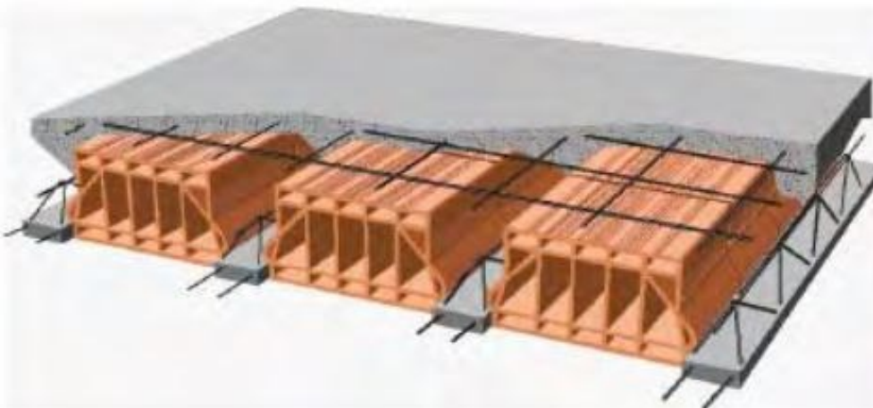
Figura 7: Solaio in latero-cemento a travetti prefabbricati.
