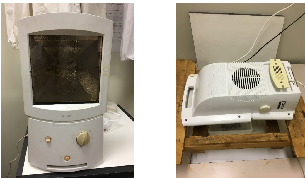
Figura 33: Lampada UVA utilizzata per irraggiare i vari campioni e come viene disposta durante gli esperimenti
