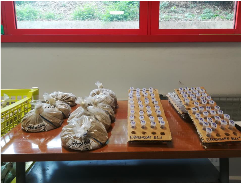
Fig.31 Eppendorf con all'interno il suolo da analizzare
