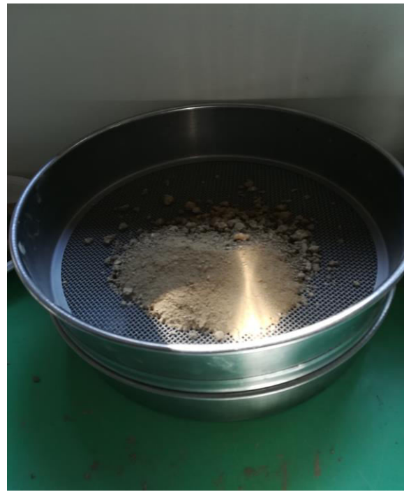
Fig.26 Setacciatura del campione
