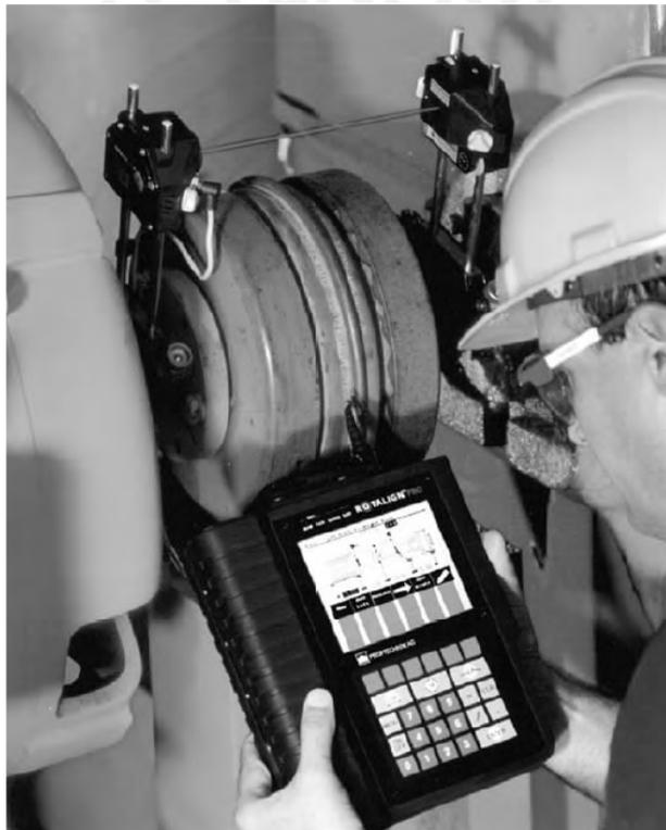
Figura 3-40. Sistema de alineamiento láser. Modelo Rotalign Pro. (PRUFTECHNIK, 2017)
