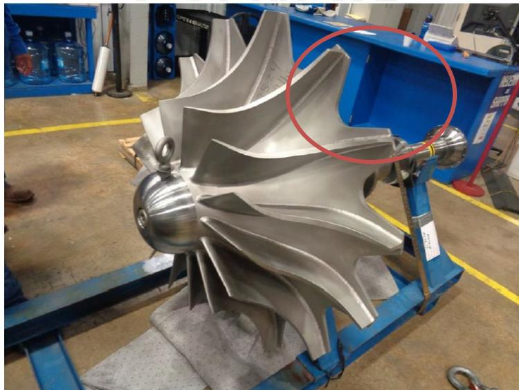
Figura 4-5. Nueva geometría del rotor después de una modificación en el diseño: se extrajo porciones del rotor (Grebinyk, Gowreesan, & Guerrero, 2018)
