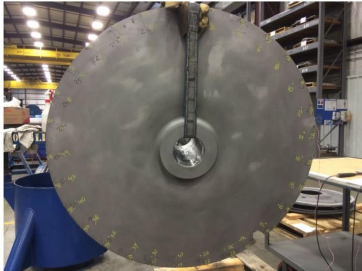
Figura 4-3. Configuración en la parte posterior del rotor para realizar la prueba de impacto (análisis modal) (Grebinyk, Gowreesan, & Guerrero, 2018).
