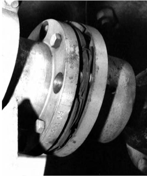
Figura 1-2. Falla del acoplamiento de disco debido un desalineamiento visible. (Piotrowski, 2007)
