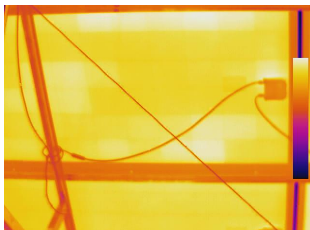
Obr. 4.8 Vada vícenásobný hotspot (vlevo), vady hotspot snímané zezadu (vpravo)
