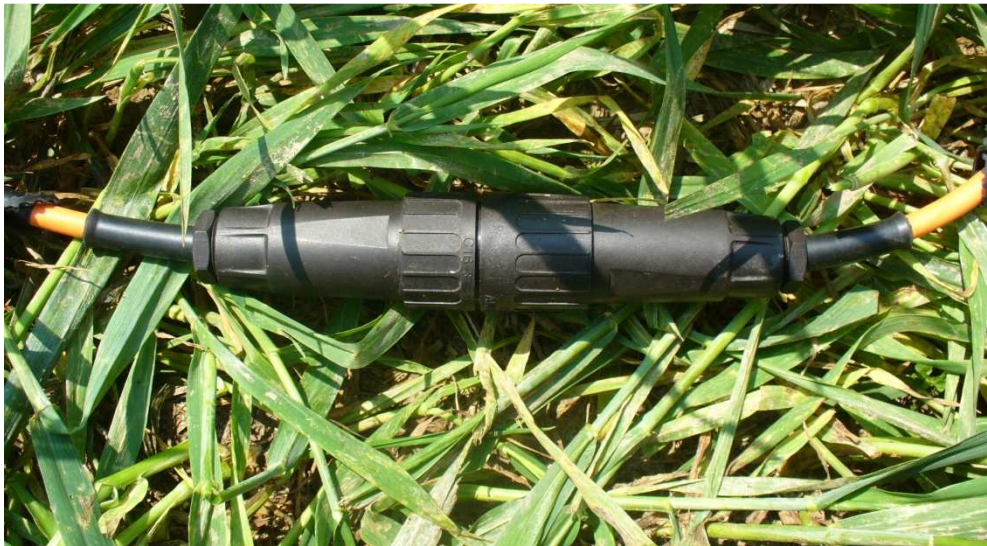
Příloha 2: Spoj jednotlivých multielektrodeových kabelů. Zdroj: vlastní fotografie.
