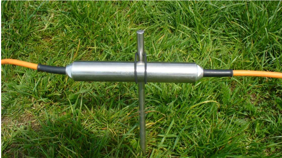
Příloha 1: Část multielektrodevého kabelu se zavedenou nerezovou elektrodou. Zdroj: vlastní fotografie.
