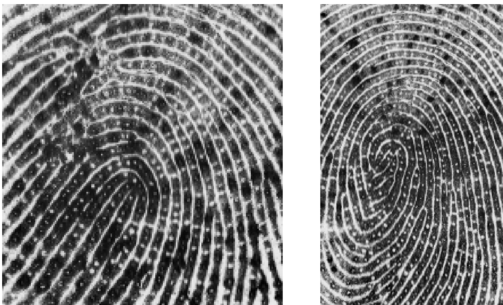
Obrázek 2.11: Výřez snímku skutečného otisku prstu s patrným rozmístěním potních pórů nasnímané senzorem Sagem MS 300
