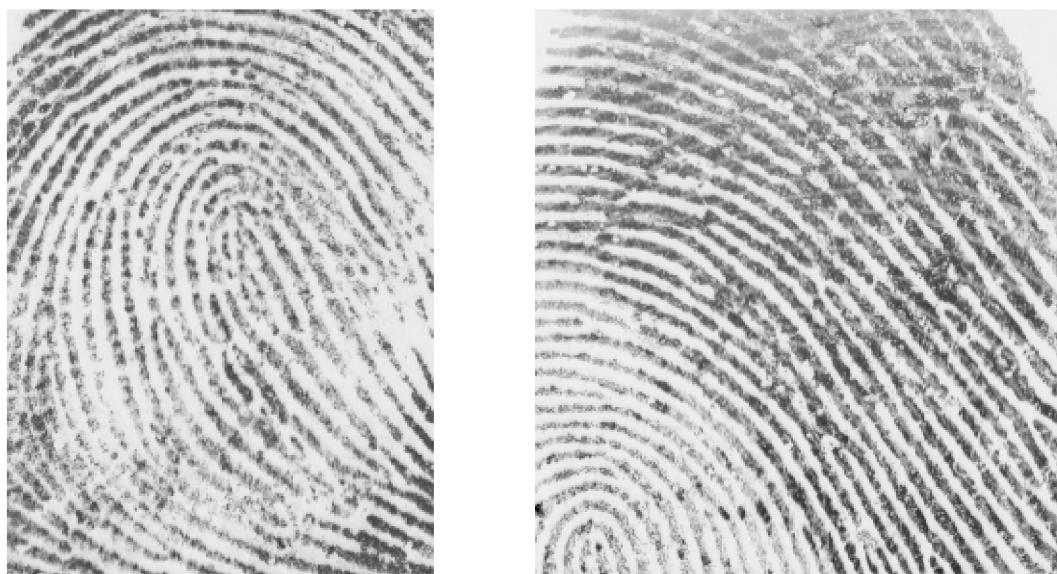
Obrázek 2.10: Výřez z falešných otisků prstů vyrobených ze želatiny (vlevo) a gumy (vpravo) nasnímané senzorem Sagem MS 300
