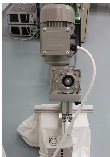
(a) Boční pohled na motor s převodovkou (b) Přední pohled na motor s převodovkou
