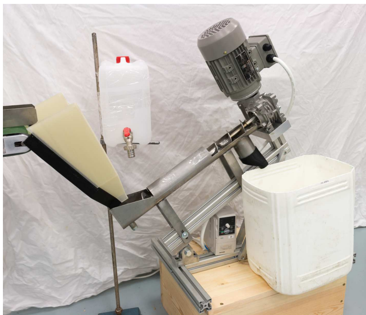
Obrázek 5.8: Pohled na zařzení pro nanesení biopreparátu na povrch semen
