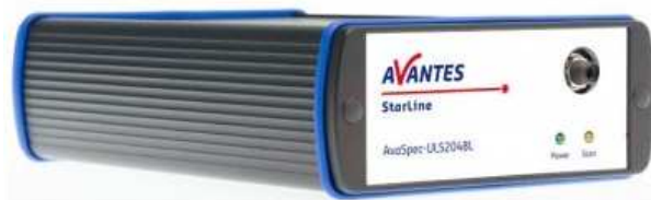
Obrázek 3.11: Přístroj na měření optických spekter AvaSpec-ULS2048-USB2
