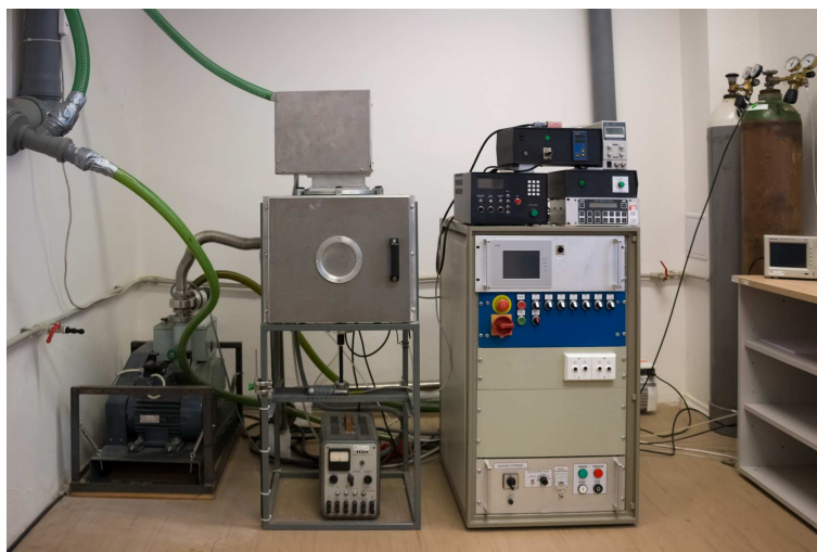
Obrázek 3.2: Pohled na aparaturu pro generování plazmatu za sníženého tlaku
