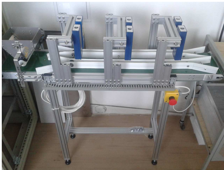
Obrázek 5.3: Pohled na pásový dopravník s dávkovacím mechanismem
