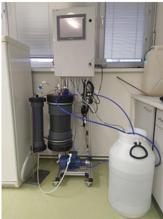
Obrázek 13 Poloprovozní jednotka kapacitní deionizace. Na fotografii malá (vlevo), aktuálně připojená, a velká elektroda (vpravo).
