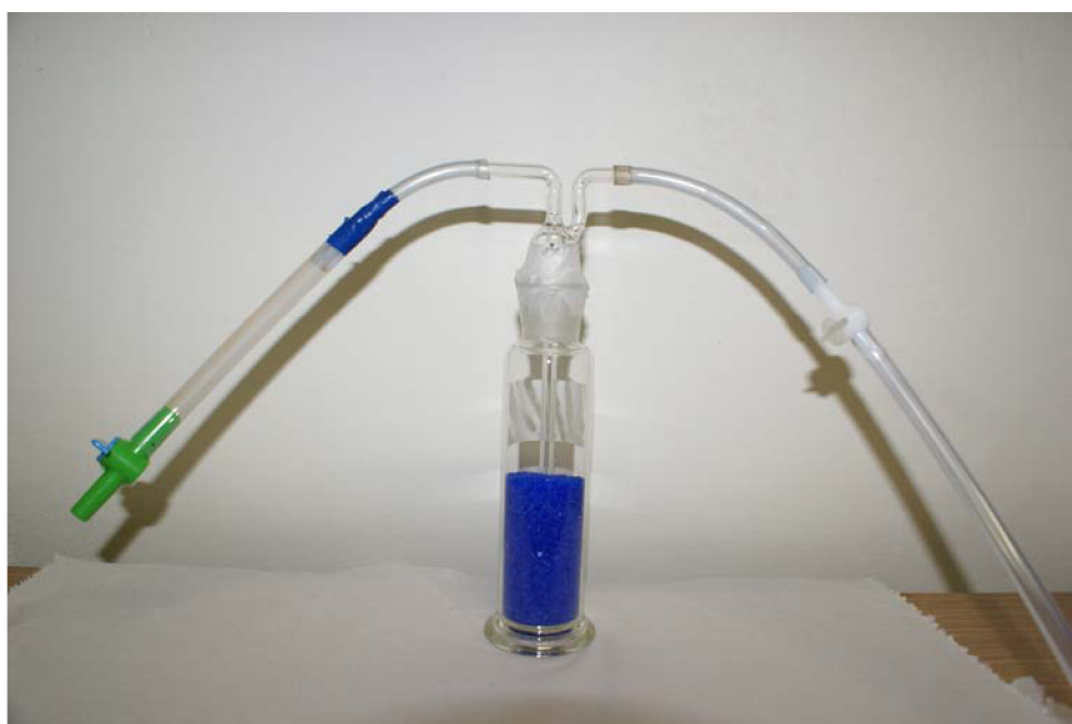
Obr. č. 34: Schéma vysoušecí sestavy přes Blaugel
