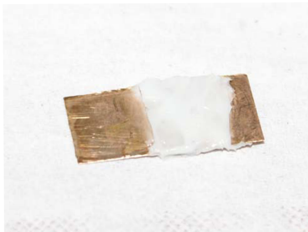
Obr. č. 31: Měděná elektroda (Velikost elektrody je ohraničena vrstvou silikonu)
