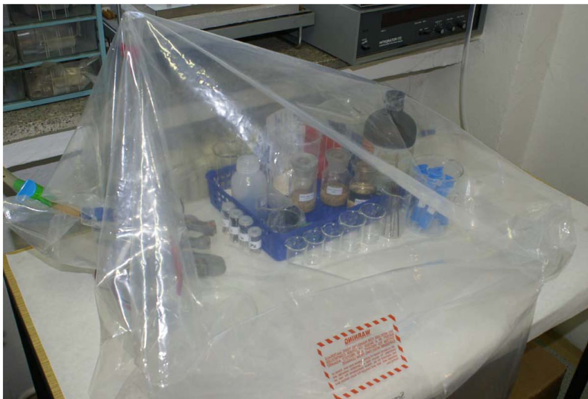
Obr. č. 29: Rukavicový box v praktickém použití
