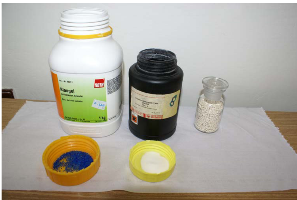
Obr. č. 33: Sada dehydratujících preprátů Zleva: Blaugel, \text{NaHCO}_3 , molekulární síto
