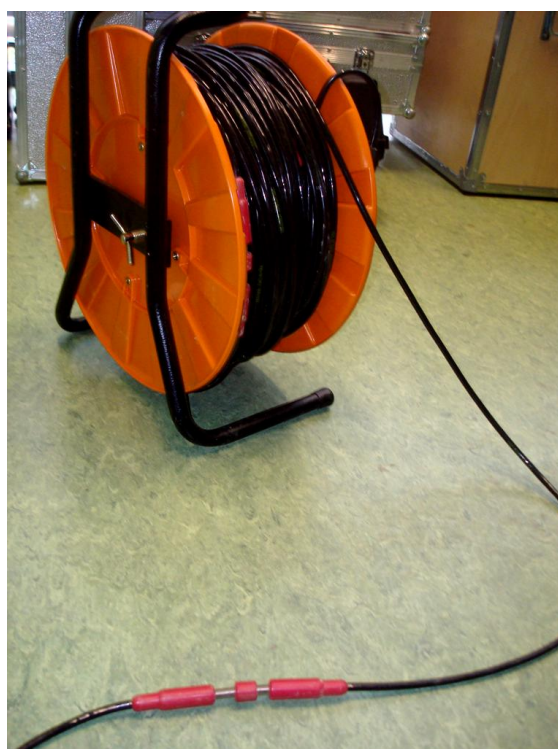
Obrázek 31 Buben s namotaným seismickým kabelem, v popředí vývod pro připojení geofonu.
