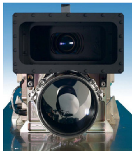
Fig. 3.3. Vue de face : HRSC est l'objectif du haut, SRC celui du bas. Une coiffe protège HRSC des lumières parasites.
