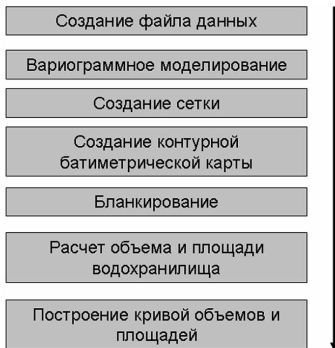
Рис.4.6. Этапы расчета объемов в программе SURFER Figure 4.6. Steps for calculation of reservoir volumes by SURFER
