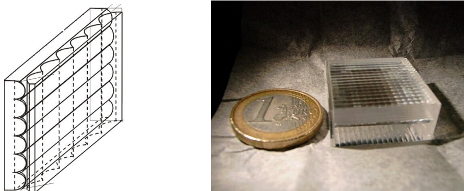
FIGURE 2.3 – Schéma (à g.) et réalisation (à dr.) du MLA à barreaux cylindriques croisés en verre de quartz de SNIFS. Figures extraites de Lantz et coll. (2004).
