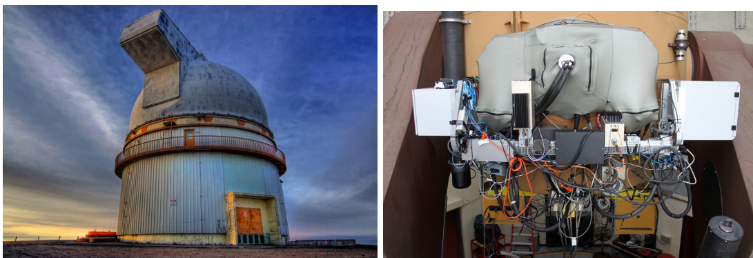
FIGURE 2.1 – À g. : le télescope UH88 de 2,2 m de l'Université d'Hawaï (source) ; à dr. : vue d'ensemble de SNIFS monté sur le port Cassegrain replié Sud du télescope (source).
