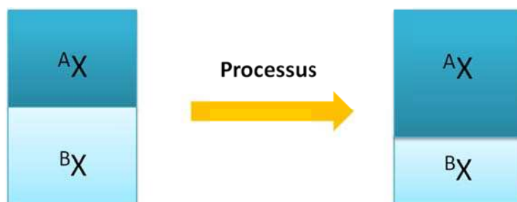
Figure I-4 : Schéma illustrant le fractionnement isotopique entre deux compartiments 1 et 2 (molécules, minérale, organismes etc...), ou la variation d'abondance entre les isotopes A et B, de l'élément X au cours d'une réaction.
