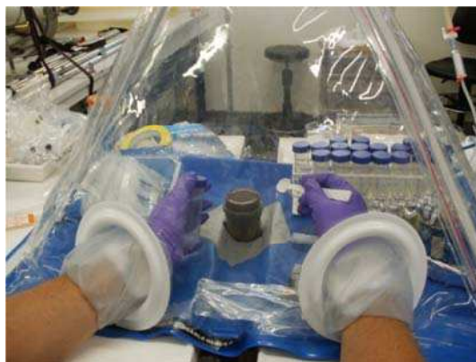
Figure II-14 : Photographie de la boîte à gants anaérobie utilisée lors du découpage et du traitement des carottes «géomicrobiologie».
