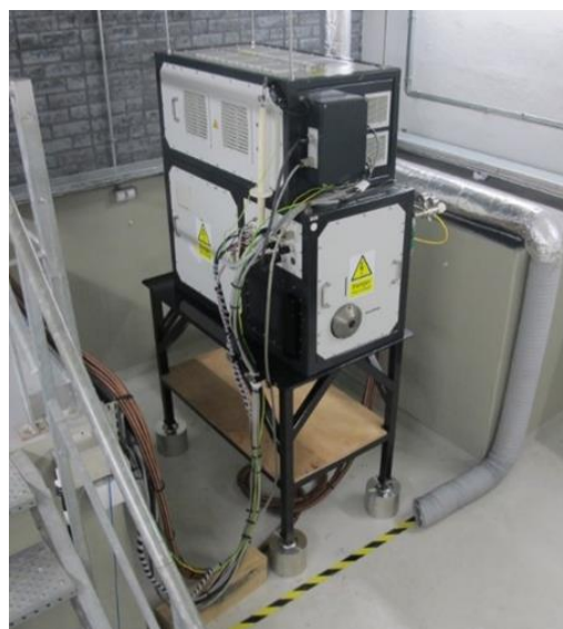
Figure II.21 : Vue d'ensemble de l'accélérateur ORIATRON.
