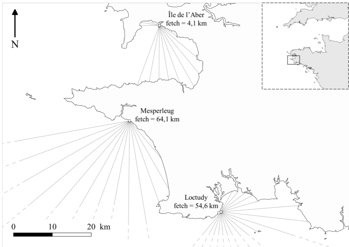
Figure 21 : Calcul du fetch sur trois sites de la pointe bretonne. NB : certains rayons particulièrement longs ont été tronqués par souci de représentation.
