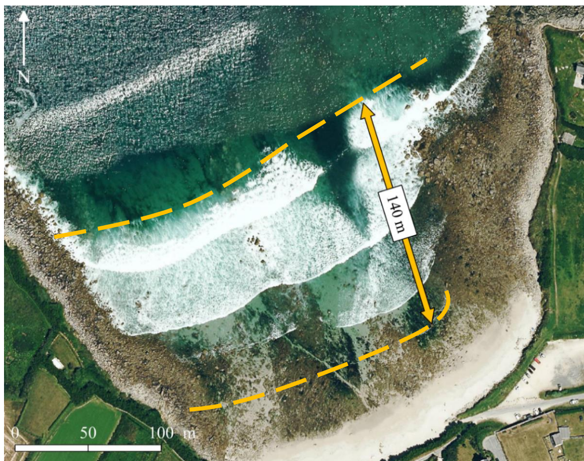
Figure 20 : Méthode de mesure de la distance de déferlement sur le site de Moguériec (Sibiril), les traits pointillés délimitent la zone de déferlement, la mesure de la distance de déferlement, ici 140m, est effectuée à l'endroit où les points ont été échantillonnés. Source : Mégalis Bretagne et collectivités territoriales bretonnes – 2012.
