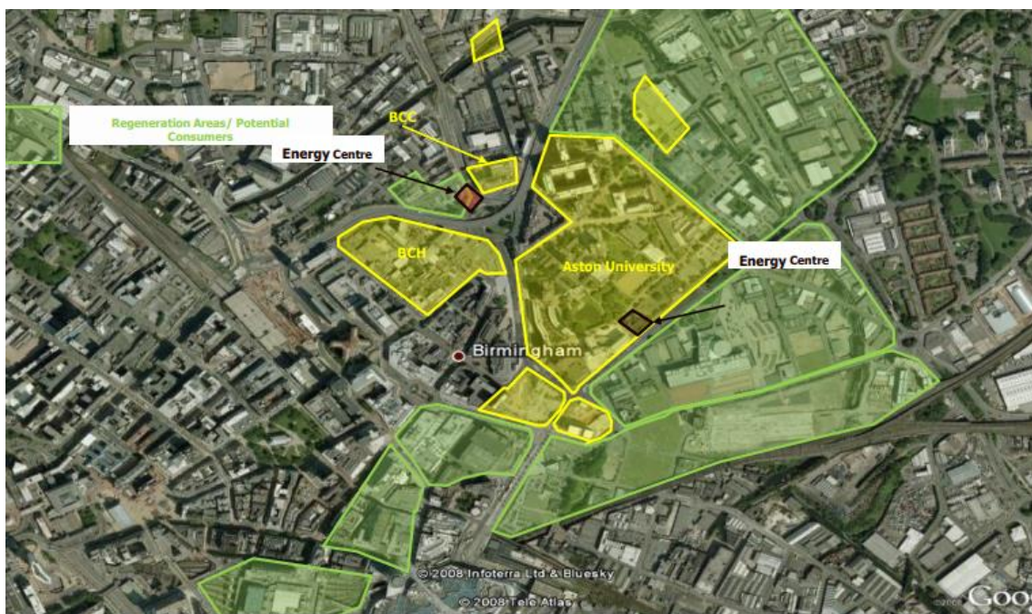
Figura 53, Aree di presenza e possibile futura espansione della rete di teleriscaldamento "East Side Scheme". Fonte: Energy Efficiency Involving and working with local stakeholders: Birmingham District Energy Scheme. PDF di presentazione dell'iniziativa, reperibile al link http://www.wmemployers.org.uk/media/upload/Cofely%20Energy.pdf
