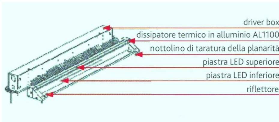
Figura 4.7 – Caratteristiche del proiettore V400.
