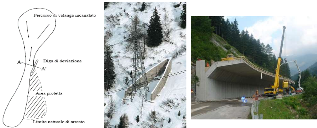
Figura 13: opere di deviazione della valanga. A sinistra schema funzionamento diga di deviazione (fonte: Mears, 1989), in centro foto di un cuneo frangi valanga e a destra foto di un By-Pass (fonte: D'Agostino, 2021).
