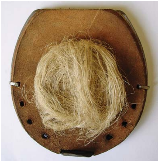
► Abb. 3.23 Hufeisen mit Lederplatte und Wergeinlage mit durchgebrannten Nagellöchern und umgelegten Hufnägeln zum Fixieren.
